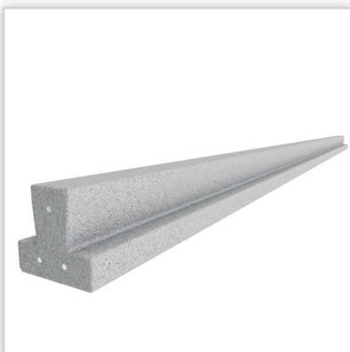
System Stropowy MASTER. Rozpiętość stropu: maks 9,3 m. Wysokość konstrukcyjna stropu: w zależności od wariantu pustaka. Grubość nadbetonu: w zależności od wariantu pustaka. Osiowy rozstaw belek: 60 cm. Waga 1 m 2 stropu: w zależności od wariantu pustaka. Przenoszone obciążenia: do 30 kN/m 2 . Wysokość belki: 11 cm. Szerokość belki: 12 cm. Długość belki: maks 9,3 m. Klasa betonu: C50/60. Waga: 23 kg/m 2 .
