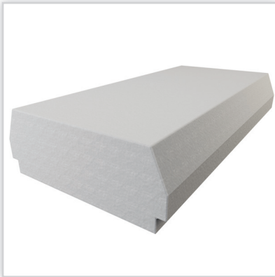
Strop Teriva 24/60 LIGHT. Rozpiętość stropu: maks. 7,2 m. Wysokość konstrukcyjna stropu: 24 cm. Grubość nadbetonu: 4 cm. Osiowy rozstaw belek: 60 cm. Waga 1 m 2 stropu: około 188 kg. Klasa energetyczna: A+ (R=3,088). Wysokość pustaka: 20 cm. Długość pustaka: 100 cm. Szerokość pustaka: 48 cm. Waga pustaka: 1,6 kg/szt. Ilość na palecie: 16 szt.
