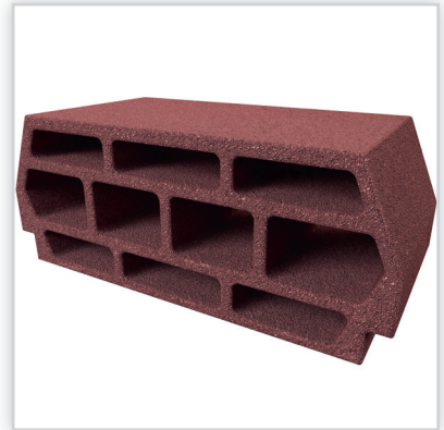
Strop Teriva 24/60 BASE 10-KOMOROWY TERMO. Rozpiętość stropu: maks. 7,2 m. Wysokość konstrukcyjna stropu: 24 cm. Grubość nadbetonu: 3 cm. Osiowy rozstaw belek: 60 cm. Waga 1 m 2 stropu: ok. 228 kg. Klasa energetyczna: A (R=0,874). Wysokość pustaka: 21 cm. Długość pustaka: 24 cm. Szerokość pustaka: 48 cm. Wariant produktu: keramzyt lub beton. Waga pustaka: 13 kg/szt. Ilość na palecie: 60 szt.
