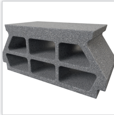
Strop Teriva 5-KOMOROWY TERMO 24/60 PLUS i 28/60 PLUS. Rozpiętość stropu: maks. 7,5 m. Wys. kontr. stropu: 24 lub 28 cm. Grubość nadbetonu: 0 lub 4 cm. Osiowy rozstaw belek: 60 cm. Waga 1 m 2 stropu: 257-359 kg. Klasa energetyczna: A (R=0,844). Wysokość pustaka: 24 cm. Długość pustaka: 24 cm. Szerokość pustaka: 48 cm. Wariant produktu: keramzyt lub beton. Waga pustaka: 14-15 kg/szt. Ilość na palecie: 48 szt.
