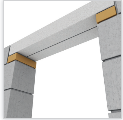
SBN 100/120. Wysokość: 100 mm. Szerokość: 120 mm. Rozpiętość: od 1,2 do 4,2 m. Klasa betonu: C40/50. Waga: 30 kg/mb. Ilość na palecie: od 18 do 27 szt.
